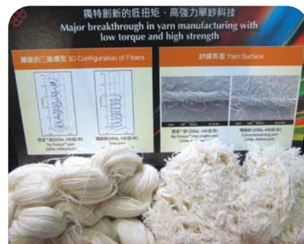
Nu-Torque紗線(左)減少紗線之間的並捻情況，且表面較傳統紗線(右)光滑，用來編織布料時，不用化學添加劑處理，減少對環境的損害。
